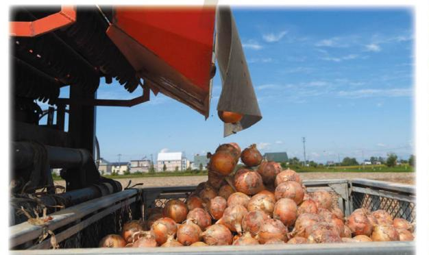
車体にコンベアがついています。地面の玉ねぎを拾い集めて大きな鉄のコンテナに収集します。
