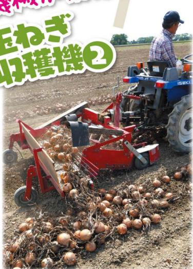
根を切る機械ですが、玉ねぎをひっくり返して乾燥する作業にも使います。3列ある玉ねぎを左右から集め、1列にする作業にも使います。
